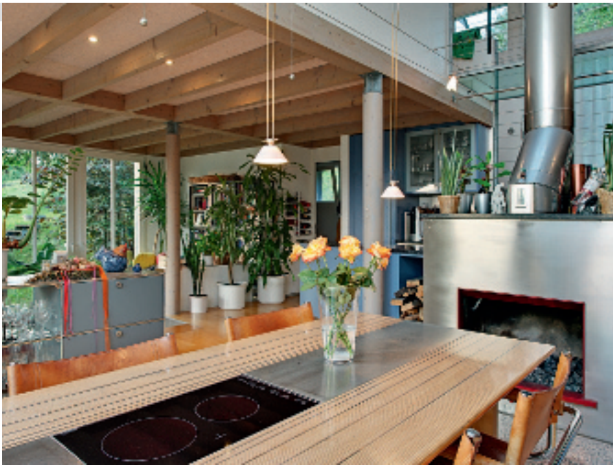
Tisch der Marke Eigenbau: Als Warmhalteplatte wurde ein Induktions-Kochfeld integriert – der Vorteil: Köchin und Koch können beim Essen sitzenbleiben; das hat sich über viele Jahre bewährt.
